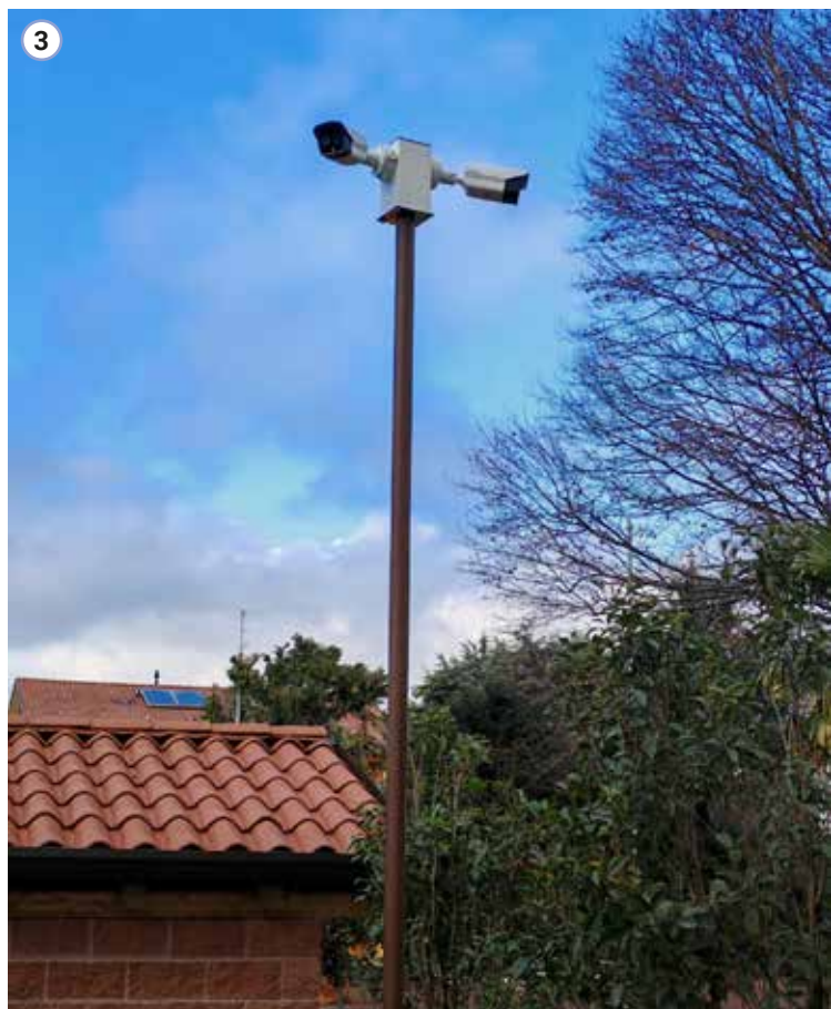
Palo Monaco60 H 4000 mm corten - torretta in alluminio 120x120x2,5 mm H 500 mm cod. TW3060AB p. 220, per testa palo Ø 60÷75 mm
