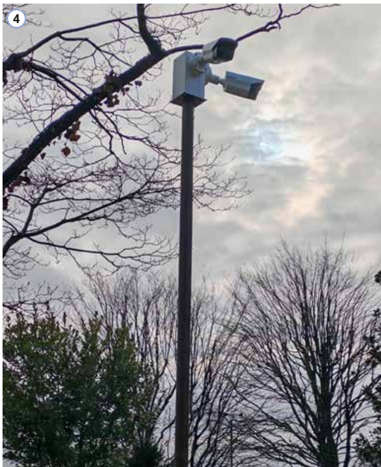
Palo Monaco60 H 4000 mm corten - torretta in alluminio 120x120x2,5 mm H 500 mm cod. TW3060AB p. 220, per testa palo Ø 60÷75 mm
