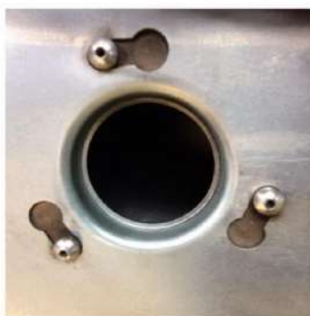
2. Attacco a baionetta sulla piastra di supporto Vista del foro di alloggiamento con sistema di fissaggio a baionetta predisposto per l'inserimento della cartuccia.
