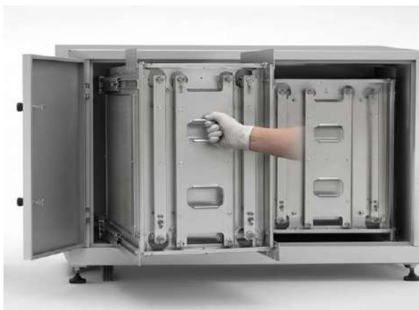
Fig. 30 – Estrazione della cella elettrostatica a sportello aperto e lavaggio in vasca a ultrasuoni.
