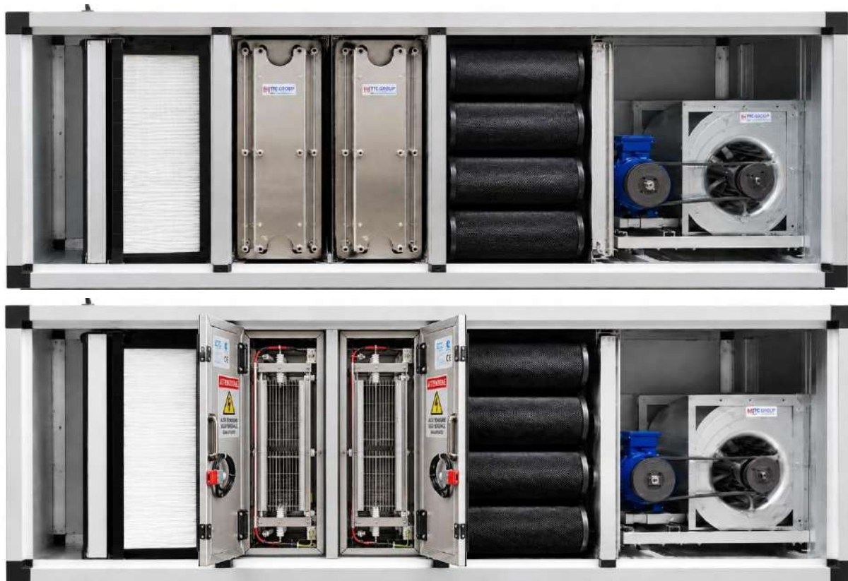
Fig. 2 – ARTURO con pannelli rimossi: da sinistra prefiltri G4/F9, cartucce a carbone attivo, filtro elettrostatico e gruppo motore-ventilatore con trasmissione a cinghia.
