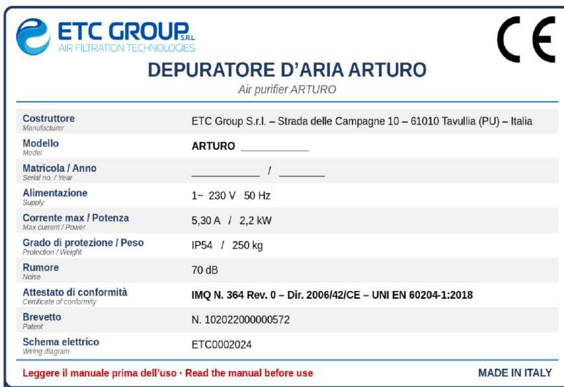
Fig. 17 – Targa di identificazione e marcatura CE della configurazione ARTURO attestata IMQ N. 364 Rev. 0 (dati dell'allegato all'attestato).
