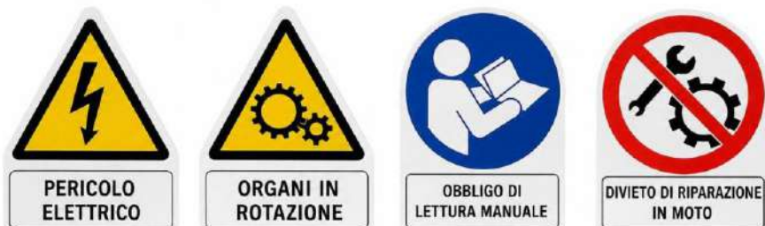
Fig. 15 – Pittogrammi: pericolo elettrico, organi in rotazione, obbligo di lettura del manuale, divieto di riparare o registrare durante il moto.
