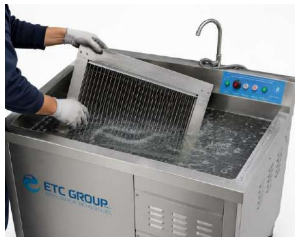
Fig. 30 – Estrazione della cella elettrostatica a sportello aperto e lavaggio in vasca a ultrasuoni.
