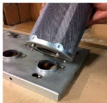
3. Inserimento e bloccaggio della cartuccia La cartuccia viene inserita nell'attacco a baionetta e successivamente ruotata fino al completo innesto e bloccaggio.
