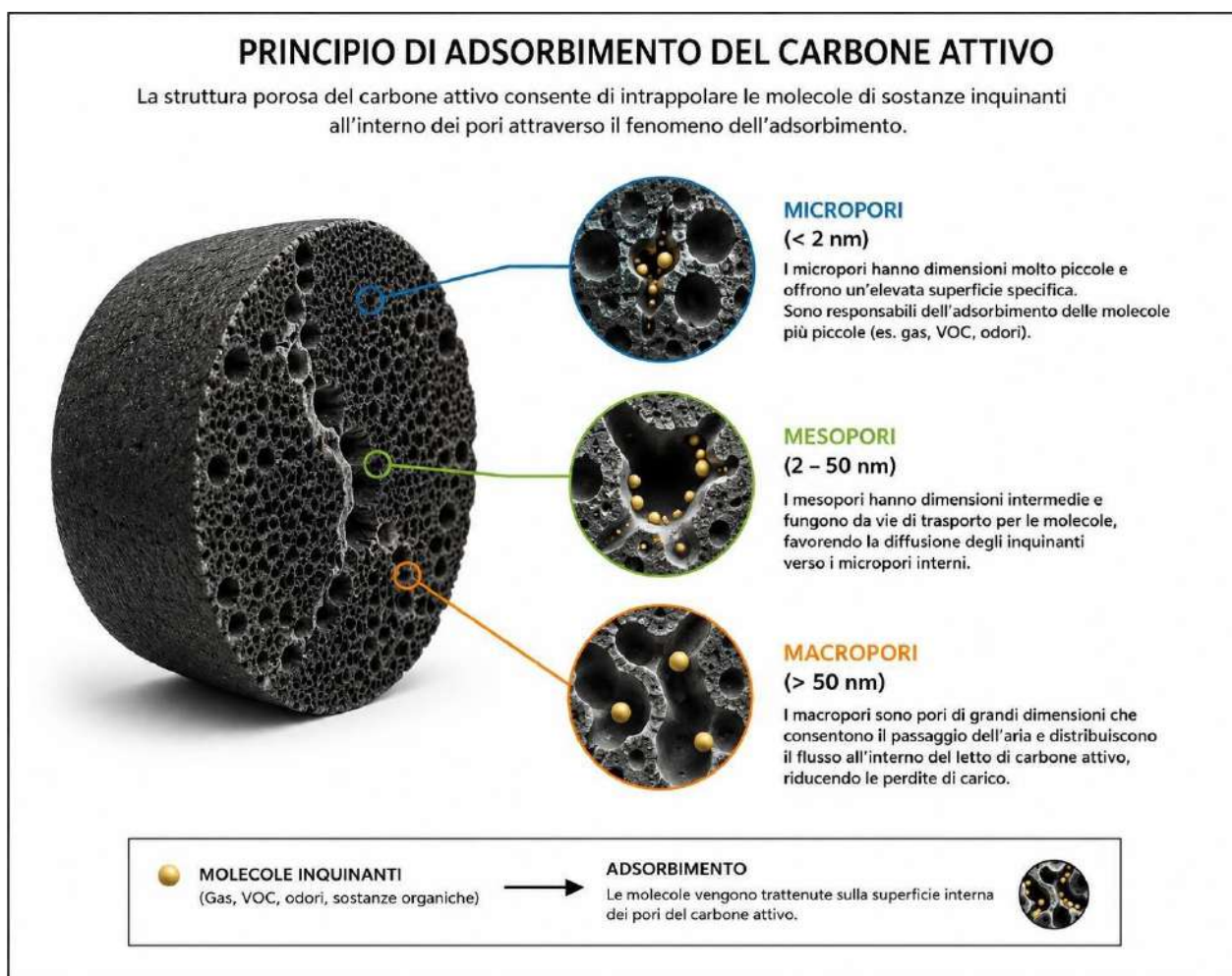
Fig. 5 – Struttura porosa del carbone attivo: micropori, mesopori e macropori trattengono le molecole inquinanti.
