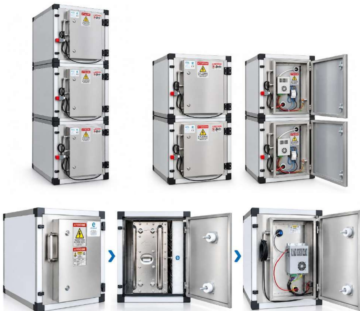
Fig. 10 – Moduli elettrostatici sovrapposti per il funzionamento a più stadi in serie (a sinistra tre stadi, a destra due stadi) e sequenza di apertura: sportello chiuso, cella in sede, alimentatore.
