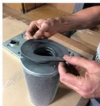
1. Applicazione della guarnizione adesiva La cartuccia viene dotata dell'apposita guarnizione adesiva in gomma nera, da applicare sulla flangia di accoppiamento per garantire la tenuta dell'aria.
