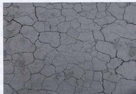
Figura 1 - Tipica fessurazione da ritiro in terreni di natura argillosa
